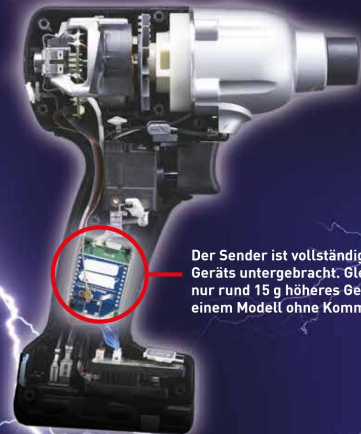
Der Sender ist vollständig im Griff des Geräts untergebracht. Gleiche Größe und nur rund 15 g höheres Gewicht als bei einem Modell ohne Kommunikation.
