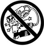
**BETREIBEN SIE DAS GERÄT NICHT MIT SAUERSTOFF, BRENNBAREN GASEN ODER FLASCHENGASEN, DA DAS GERÄT EXPLODIEREN UND VERLETZUNGEN VERURSACHEN KANN.**
