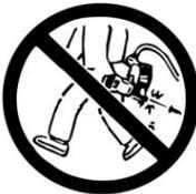
Auf dem Geräteanschluss darf beim Entfernen der Luftzufuhr kein Druck anliegen. Bei Verwendung von falschen Anschlussstücken kann das Gerät nach dem Trennen mit Druckluft befüllt bleiben und so auch nach Abziehen der Druckluftleitung ein Befestigungselement einschlagen. Dies kann zu Verletzungen führen.
