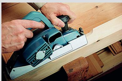
Speziell entwickelt zum Anfasen von Kanten.
